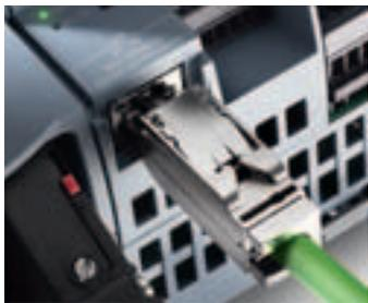
La interfaz PROFINET integrada puede usarse indistintamente para la programación o para la comunicación HMI o de CPU a CPU. Además, permite la comunicación con equipos de otros fabricantes, mediante protocolos abiertos de Ethernet. Esta interfaz ofrece una conexión RJ45 con función Autocrossing y permite velocidades de transferencia de datos de 10/100 Mbits/s. Son posibles hasta 16 conexiones Ethernet, mediante los siguientes protocolos: TCP/IP nativo, ISO-on-TCP y comunicación S7.
